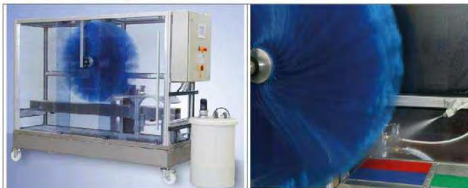
Fig N°12 : Car wash test apparatus
