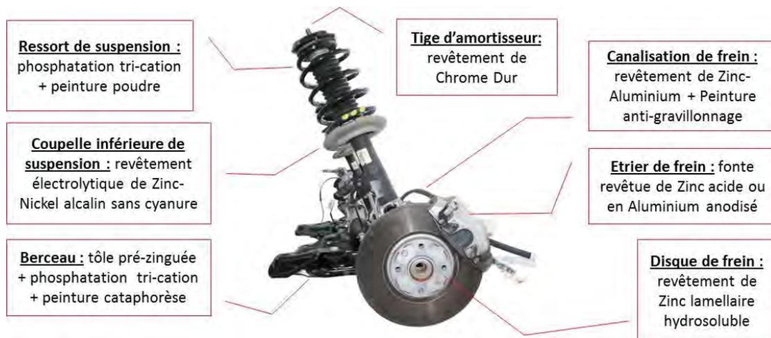
Quelques exemples de revêtements anticorrosion (train avant)
