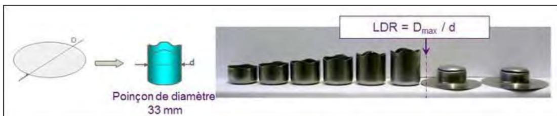
Figure 5 : Représentation du coefficient LDR (Limite Drawing Ratio)
