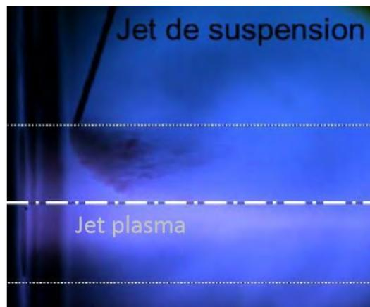
Fig.12 : Observation par caméra rapide de l'insertion d'une suspension liquide dans un jet plasma, dans le procédé SPS, d'après [19]
